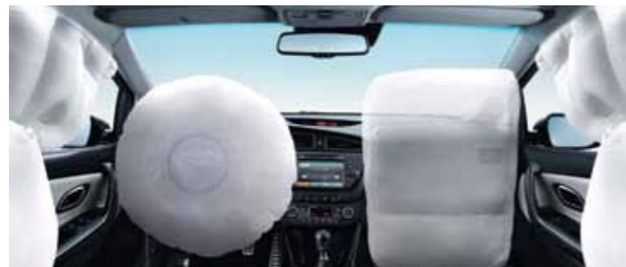
وسائد هوائية أمامية + جانبية + ستائر أمامية (٦ وسائد هوائية) Front + Side + Curtain Airbags (6 Airbags)
